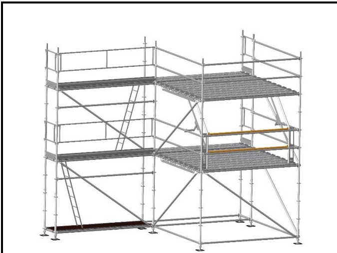
5 Assembler les deux portiques basculants par des longerons de 2,50m
